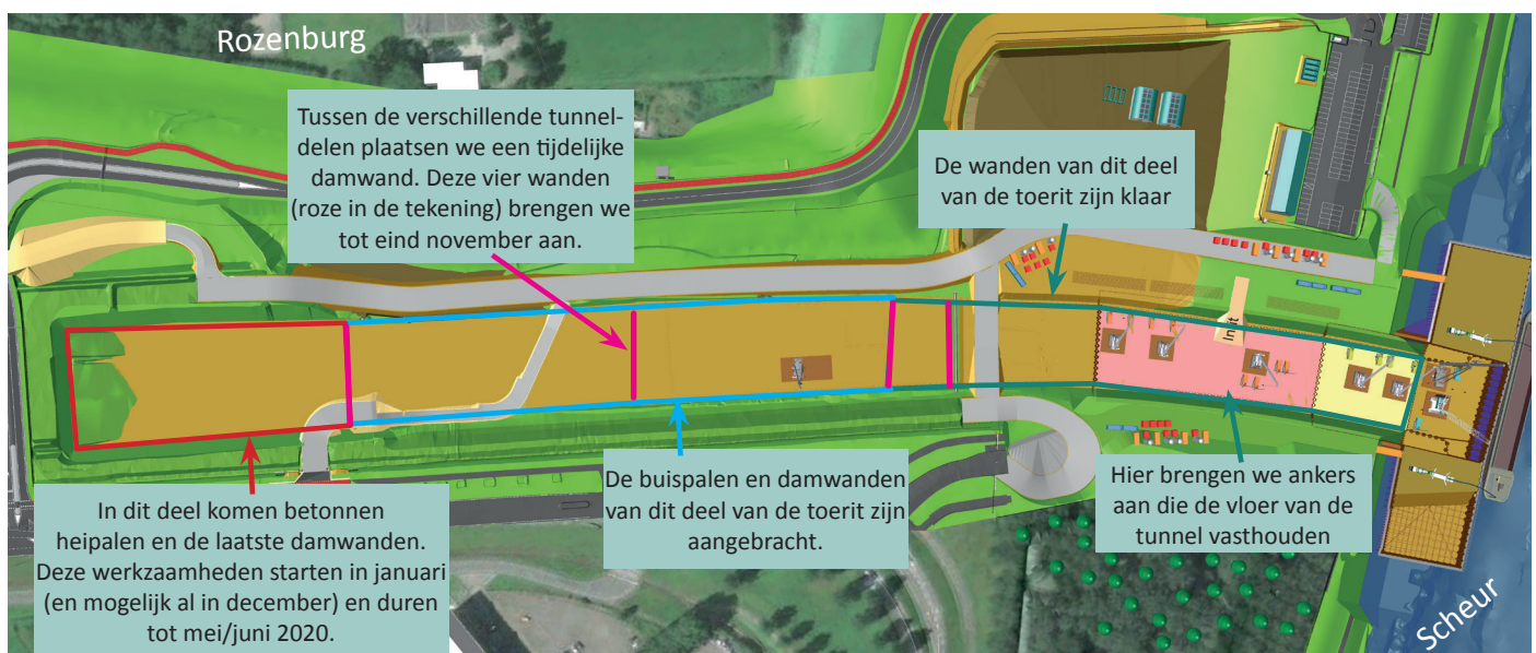
Afbeelding 2 Overzicht funderingswerkzaamheden Maasdeltatunnel
