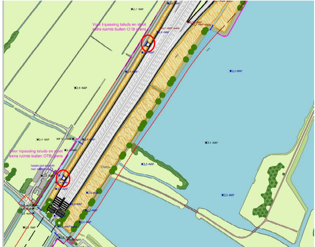
Afbeelding 2.7. Positie trappen ten noorden van tunnel
